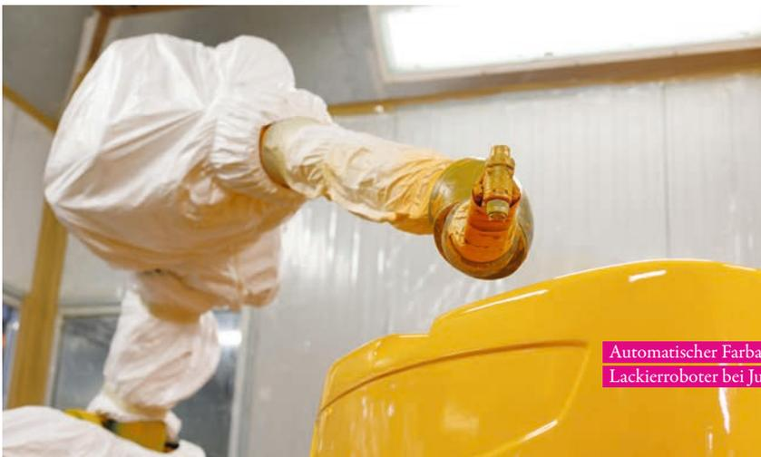
Automatischer Farbauftrag durch einen Lackierroboter bei Jungheinrich in Moorburg
